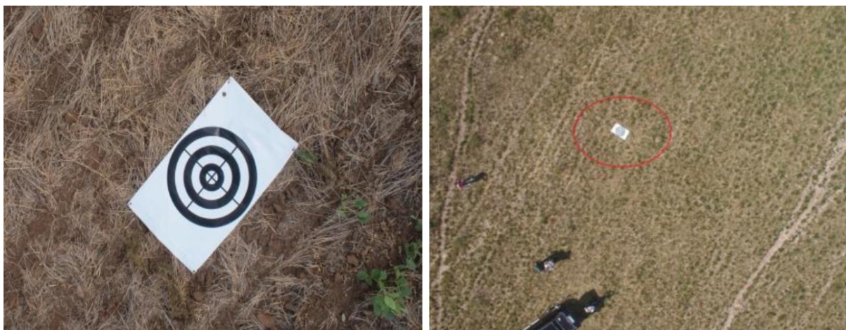
Figura 37 – Exemplo de ponto de controle. À esquerda, detalhe do ponto de controle e a direita a identificação do mesmo em imagem aérea.
